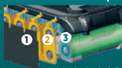
1: izolacioni plašt 2: film 3: vodo-otporni obruč Trostruka zaštita sprečava da dođe do kvara ćelije zbog ulaska voda i prašine.
