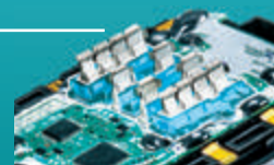
Zaštita od kratkog spoja se zasniva na zidovima kućišta akumulatora, između konektora, koji sprečavaju prodiranje vode i prašine.
